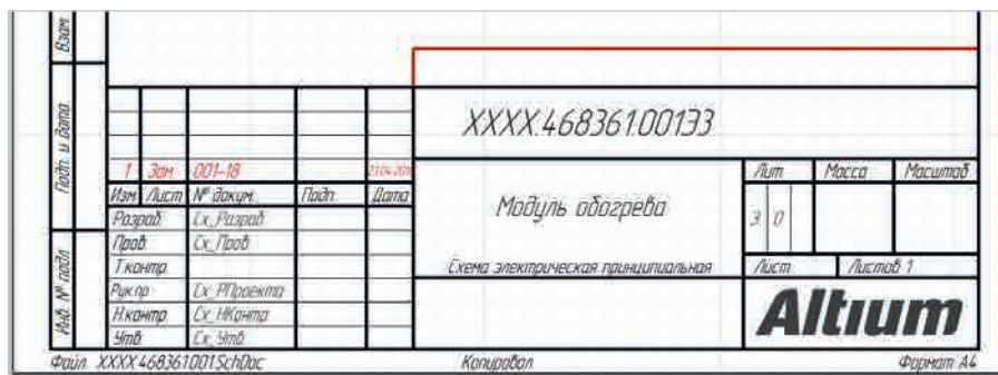
Рис. 4. Пример заполненной основной надписи листа схемы
